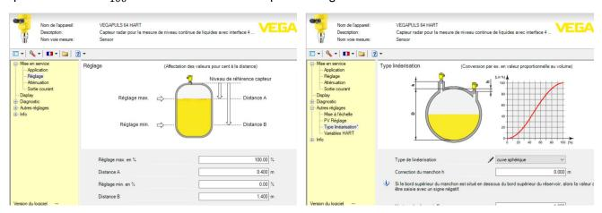
Le niveau peut être converti en volume en configurant la géométrie du réservoir (cylindrique, sphérique) ou en entrant directement un tableau de correspondance « Niveau - Volume ».
