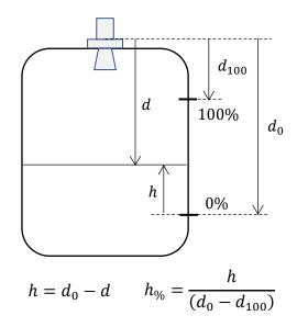
Le capteur mesure intrinsèquement d à partir de la durée  $\Delta t$  de parcours de l'onde (capteurs à technologie Time Of Flight).
